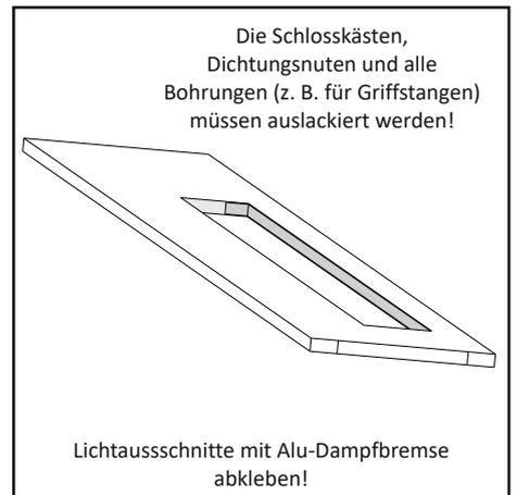
Die Schlosskästen, Dichtungsnuten und alle Bohrungen (z. B. für Griffstangen) müssen auslackiert werden!
